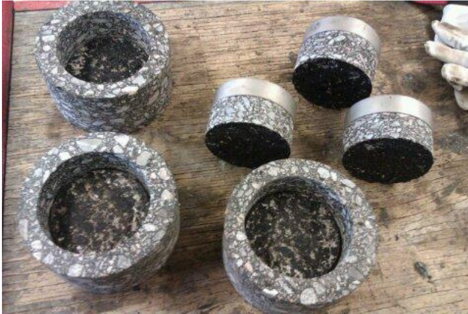
Figur 10 visar dragtestade prover där brott skett i gränssnittet. Figuren visar också hur provplattorna är applicerade. (Foto: Rebecka Magnusson, 2012).
