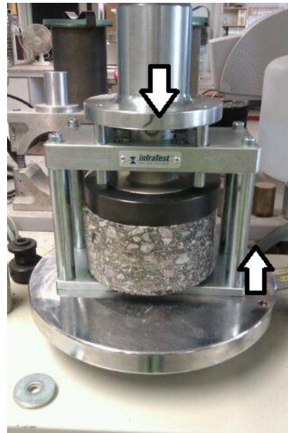
Figur 5 visar dragtestets mekanism. Plattan som modulen är placerad på trycker upp modulen medan den övre delen hålls still. Det leder till att en kraft tillförs provet. (Foto: Rebecka Magnusson, 2012).
