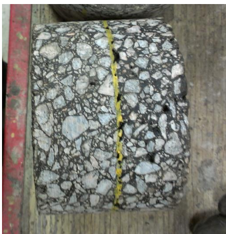
Figur 16 visar det höga hålrummet runt gränssnittet på de provkroppar som gav det lägsta värdet, både vad gäller drag- och skjuvtest. (Foto: Rebecka Magnusson, 2012).
