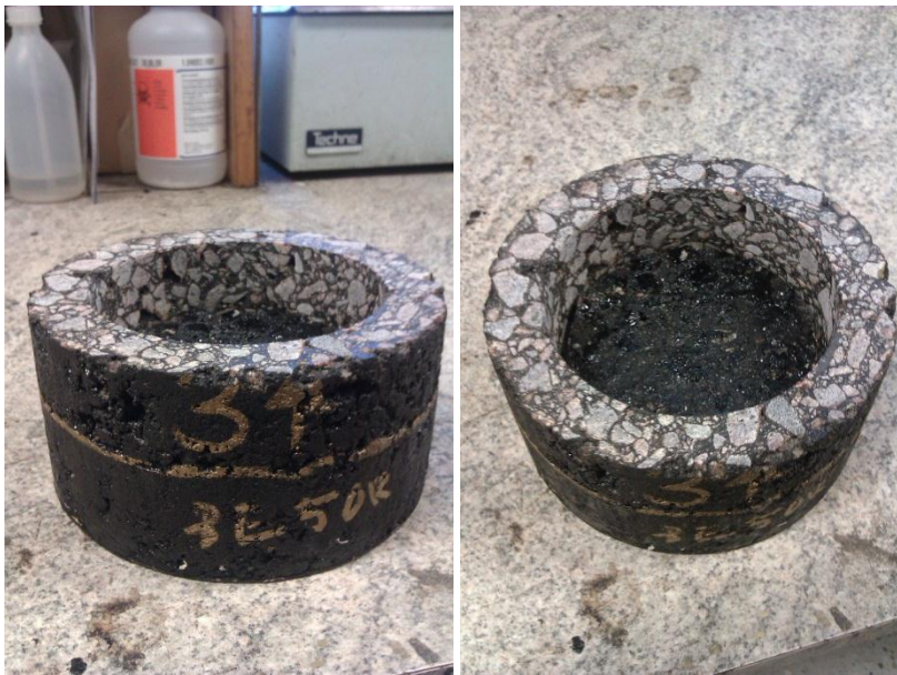
Figur 9 visar en dragtestad provkropp klistrad med BE50R, som gått i brott i gränssnittet. (Foto: Rebecka Magnusson, 2012).
