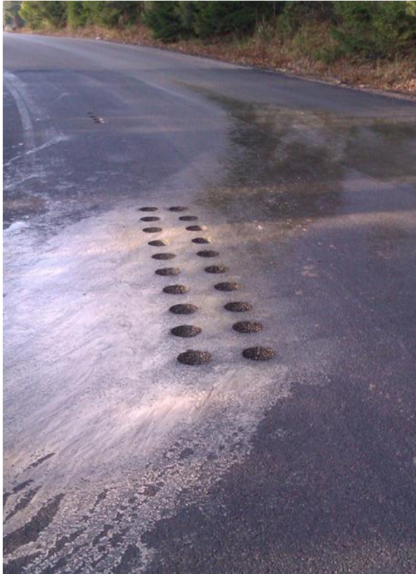
Figur 14 visar borrningen på provytan vid infarten till asfaltverket i Porsen, Uddevalla (Foto: Rebecka Magnusson, 2012).
