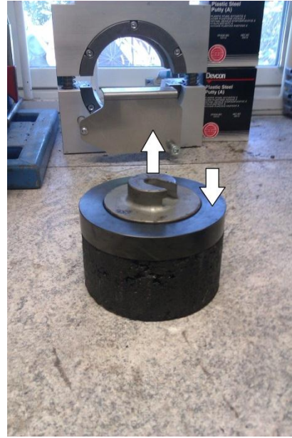
Figur 7 visar dragtestets mekanism med applicerad provplatta och stålring (Foto: Rebecka Magnusson, 2012).
