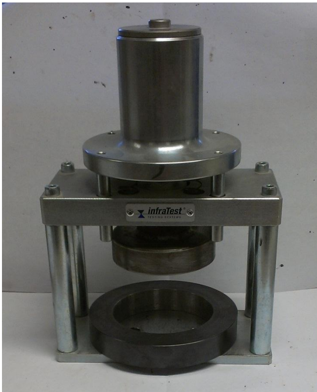
Figur 3 visar den utrustning som krävs för provning enligt Pull-Off Test Method. (Foto: Rebecka Magnusson, 2013)
