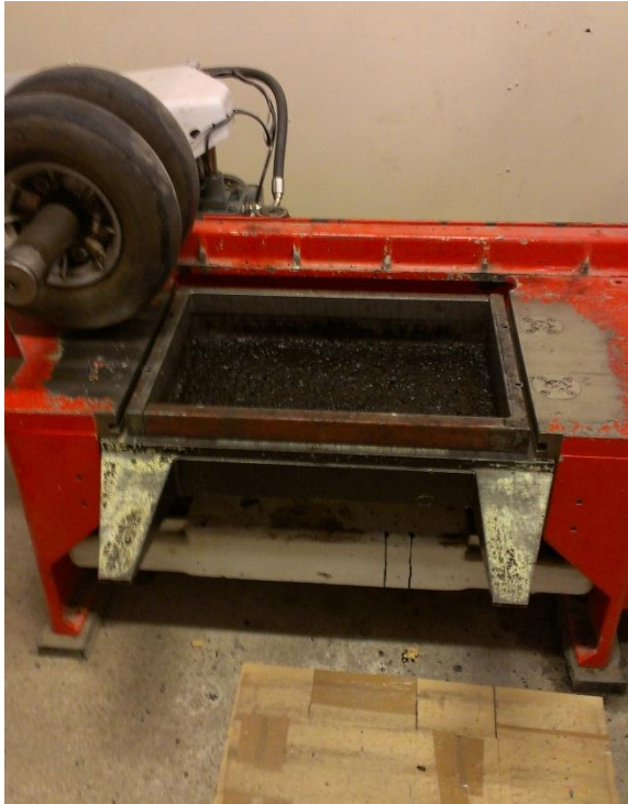
Figur 11 visar tillverkningen av provplattor, i detta fall har ett lager ABb16 packats och klistrats med BeTs (Foto: Rebecka Magnusson, 2012).
