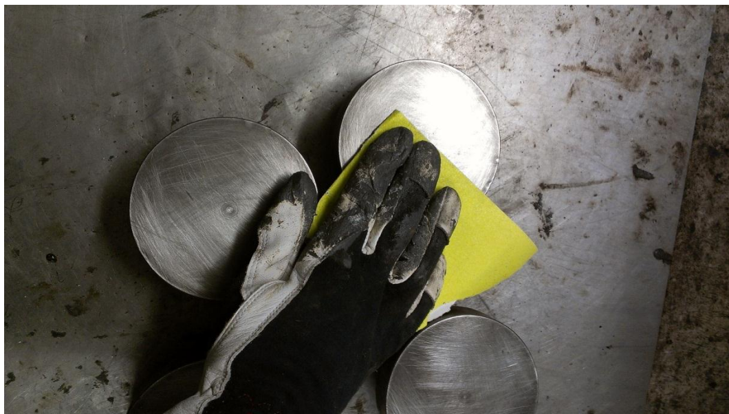
Figur 15 visar den slipning av provplattor som bör göras innan den fästs på provkroppen. (Foto: Rebecka Magnusson, 2012)
