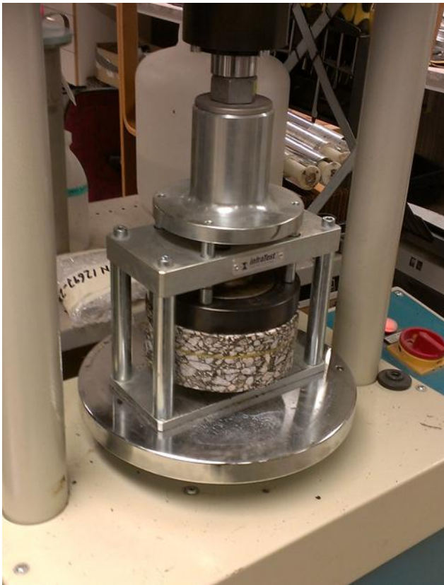
Figur 1 visar dragtestet under provning. (Foto: Rebecka Magnusson, 2012)
