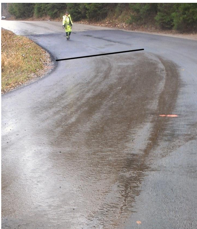
Figur 13 visar klistringen av den provyta som lades vid infarten till asfaltverket i Porsen, där det svarta strecket visar var den oklitrade ytan börjar. (Foto: Rebecka Magnusson, 2012).
