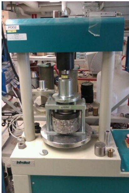
Figur 4 visar dragtestmodulen placerad i en universaltestmaskin med en provkropp som genomgår provning (Foto: Rebecka Magnusson, 2012).
