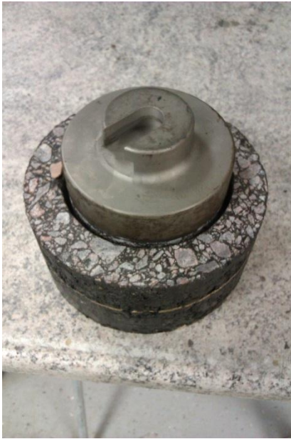
Figur 6 visar hur provkroppen ser ut när provplattan är fäst. Den visar också hur plattan sitter realterat till det borrade spåret (Foto: Rebecka Magnusson, 2012).
